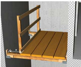
8. Bei einem Abstand [a] von mehr als 30 cm verhindert ein 3-teiliger Seitenschutz den Absturz.
